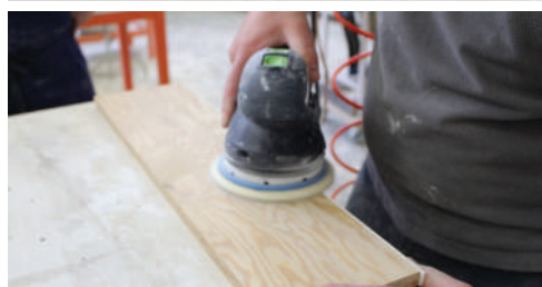
Ponçage pour rectifier le chant de 3 mm.
