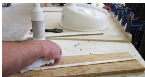
Nettoyage des pièces avant application avec le dégraissant DX5000
